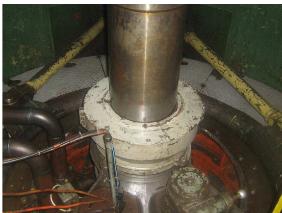
Fot. 2. Widok części koła kierownic z drążkami sterującymi [3]
