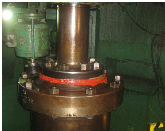
Fot. 3. Widok fragmentu wału ze sprzęgłem i prądnicą pomocniczą [3]
